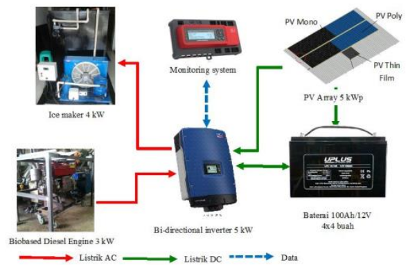
Gambar 5. Skema Rancangan Sistem Mikrogrid Cerdas Berbasis Energi Terbarukan
