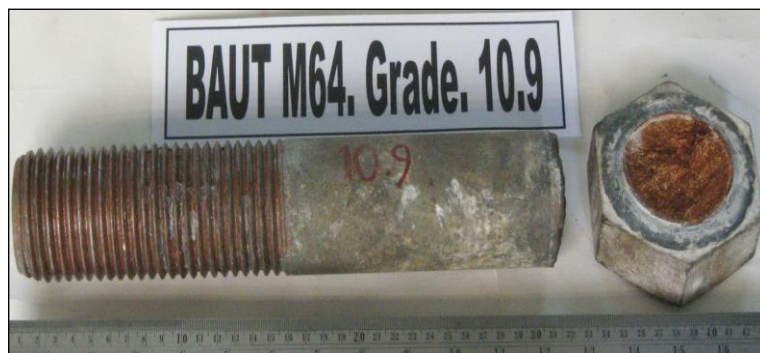
Gambar 2. Baut M64 Grade 10,9 yang Mengalami Kerusakan
