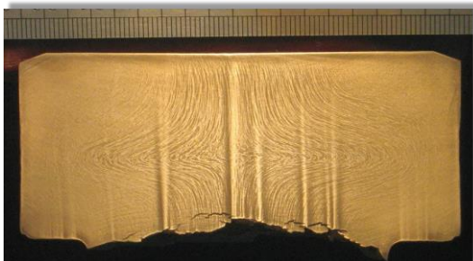
Gambar 7. Foto Makro pada Bagian Kepala Baut
