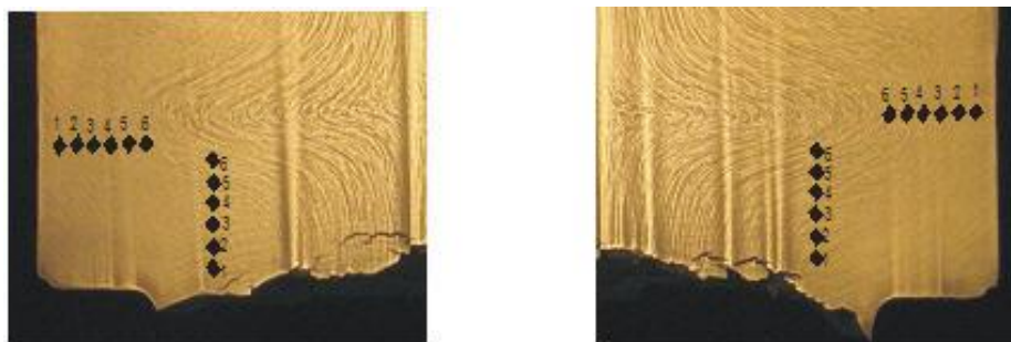
Gambar 9. Lokasi Uji Keras Vickers pada Kepala Baut
