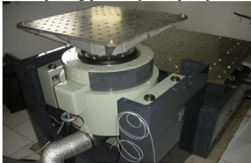
Gambar1. Vibration Testing System untuk uji getar di laboratorium B4T
