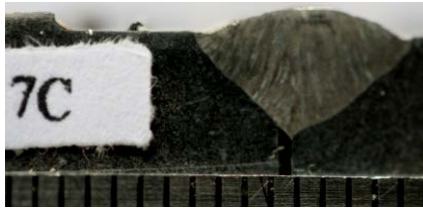
Gambar 9. Pengamatan makro proses las SMAW
