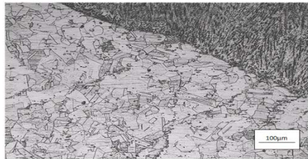
Gambar 12. Proses pengelasan SMAW di HAZ, fusion line dan WM
