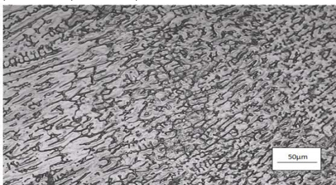
Gambar 13. Proses las A-TIG Cr_2O_3 lokasi WM
