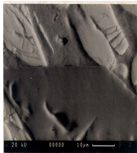
Gambar 15. Foto SEM (Backscattered) yang memperlihatkan Karakteristik Antar Muka Alumina/Matrik (Fasa Putih Adalah Al_3Ni , Warna Lebih Gelap Fasa Al). Terjadi Retakan Rambut pada Fasa Al_3Ni .
