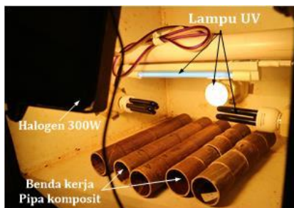
Gambar 3. Proses Perlakuan Radiasi UV pada Pipa Komposit
