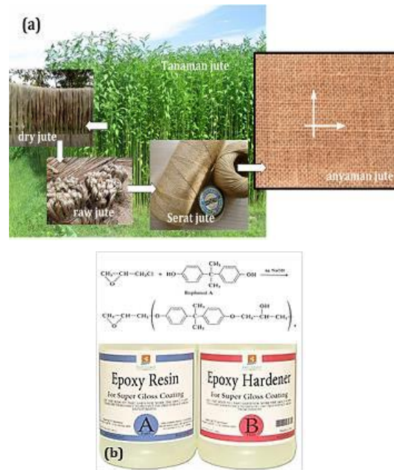
Gambar 1. a) Proses Anyaman Jute, b) Epoksi dan Hardener
