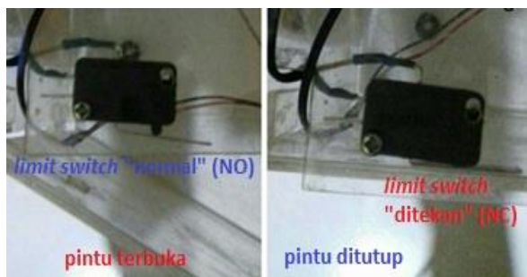
Gambar 15. Tampilan kondisi Limit Switch Terhadap Pengamanan
