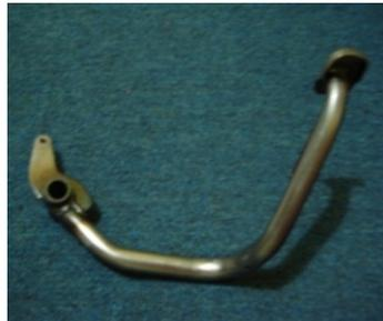
Gambar 2. Pedal Rem Setelah Dilas
