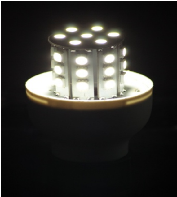
Gambar 1. Rancangan lampu LED-smd 5050
