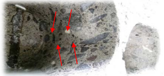
(a). Retakan Tembus Hingga Sisi Dalam
