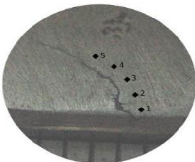
Gambar 4. Lokasi Retak dan Lokasi Pengambilan Uji Keras
