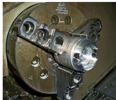
Gambar 6. Benda Kerja Hasil Spotfacing pada Dua Posisi Spot 25 mm dari Pusat Sumbu Mesin Turning. Pada Proses ini Diperlihatkan Kemampuan Mesin CNC multitasking
