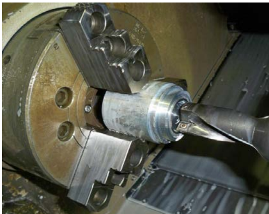
Gambar 4. Benda Kerja Hasil Dua Tahap Turning dan Posisi Pahat Siap Melakukan Proses Drilling
