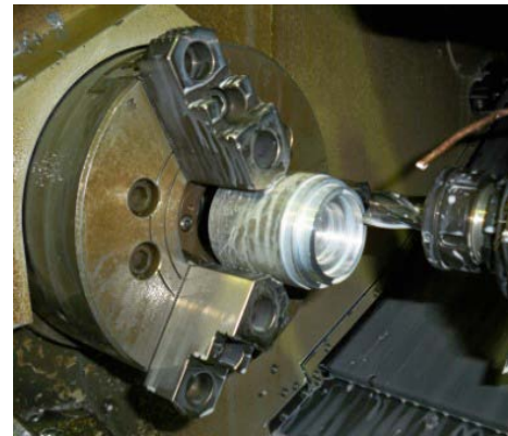
Gambar 5. Hasil Proses Center Drill (dia. 44 mm) yang Dibentuk oleh Bor 20 mm dan Posisi Bor 18 mm untuk Persiapan Proses Spotfacing
