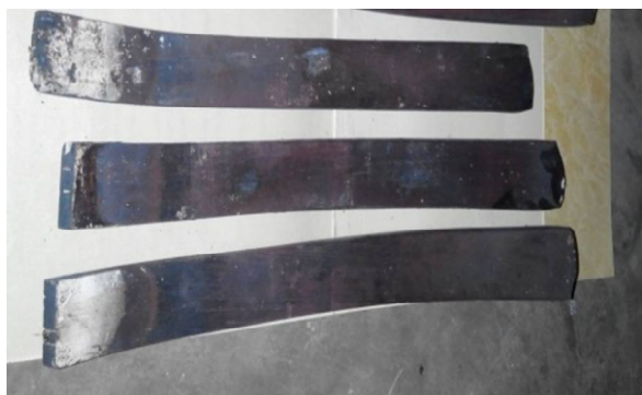
Gambar 3. Pengamatan Visual Permukaan Pelat Baja As-Cast Hasil Proses Pengerolan Panas dengan Tebal Akhir 6,5 mm
