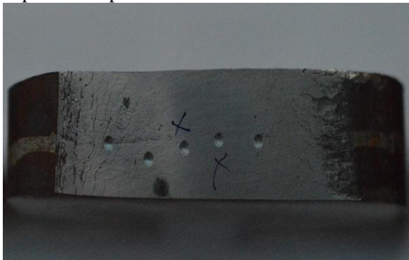
Gambar 8. Foto Hasil Uji Brinell pada Permukaan Head
