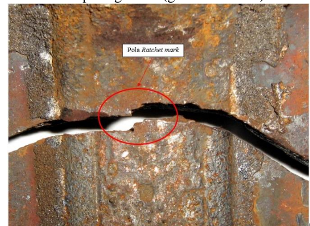
Gambar 5. Pola Ratchetmark pada Sambungan Las Termit.
