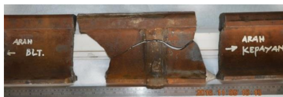
Gambar 3. Rel Kereta Api Tipe R.54 yang rusak.
