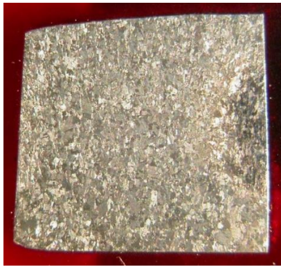
Gambar 8. Struktur Mikro Sampel Tanpa Perlakuan Panas dengan Perbesaran 10x
